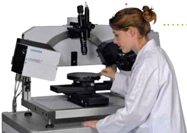
基于25年经验，UVISEL Plus相位调制椭圆偏振仪提供**纯正有效**的偏振调制，可用于各种样品的精确测量，**最新的FastAcq™快速采集技术**使得测试灵敏度提高至原有的两倍，从而能获得界面薄膜和纳米级低衬度衬底样品的更多信息
